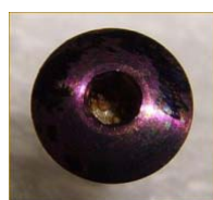
No danni alla vite di copertura
